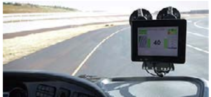
Die Elektronik-Box von invenio zeigt dem Fahrer das Erprobungsprogramm an und sammelt testrelevante Daten
