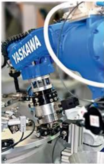
Bei der Montage der Kappe muss der YASKAWA-Sechssachser einem ausgeklügelten Bewegungsmuster folgen.
